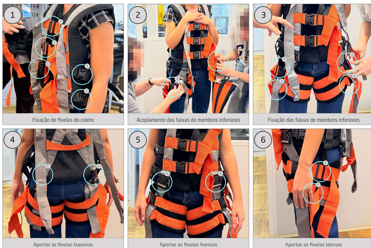
Figura 7 – Processo de acoplamento do colete auxiliar
