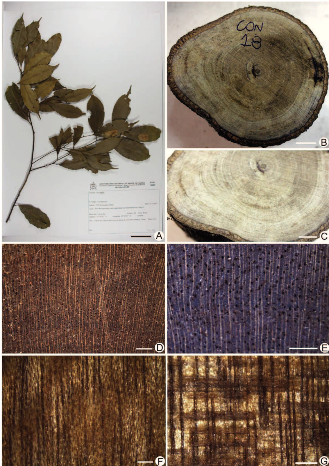
FIGURA 6: Ocotea sp. A. Ramo herborizado; B. Disco do tronco; C. Face transversal com anéis de crescimento; D. Secção transversal (10x); E. Secção transversal (20x); F. Secção longitudinal tangencial (10x); G. Secção longitudinal radial (10x). Escalas: A (4 cm); B (1 cm); C (0,8 cm); D a G (1 mm).
