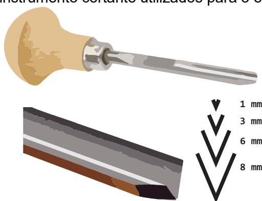
Figura 1 – Goiva: instrumento cortante utilizados para o entalhe em madeira
