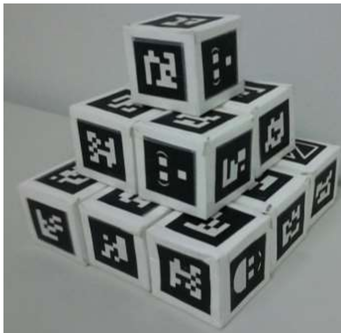
Ilustração 2 - Cubos confeccionados contendo marcadores de Realidade Aumentada. Fonte: Elaborado pelos autores, 2015.
