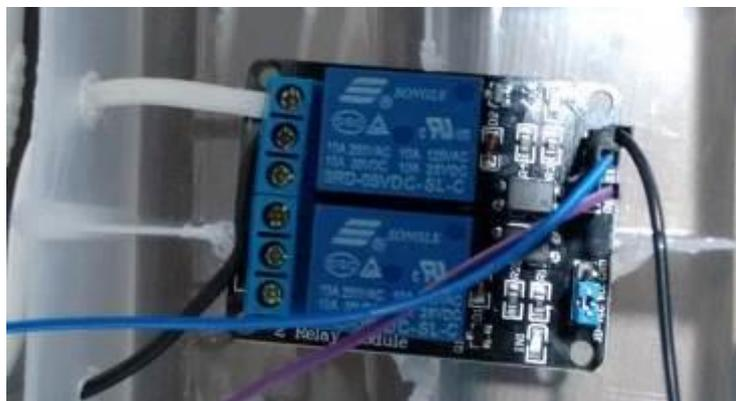
**Ilustração 10** - Relés para acionamento das lâmpadas 220v.
