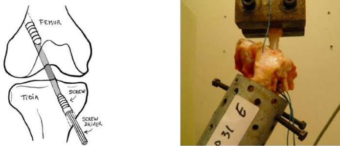
**Figura 3.** Esquema da cirurgia de reconstrução do LCA com parafuso de interferência na tibia e no fêmur (esquerda). Configuração do ensaios biomecânico (direita) (Fonte: LEBm/HU-UFSC)
