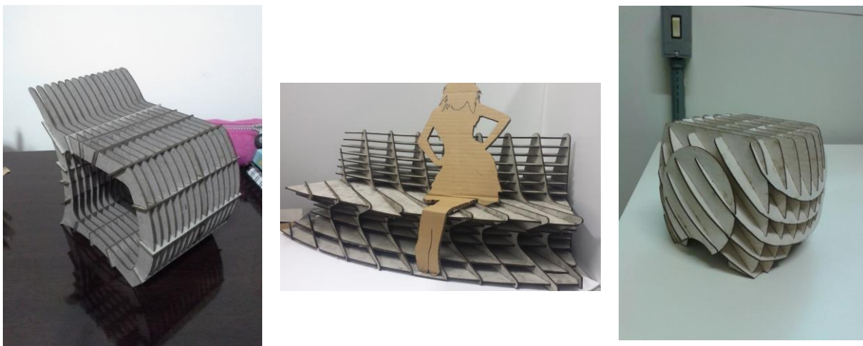
Figura 4: Trabalhos com a técnica Interlocking e corte laser em papelão Fonte: Acervo PRONTO3D
