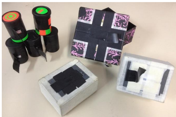
Figura 1: câmeras estenopéicas ( pinhole ) de diversos formatos e materiais produzidas no projeto À Luz da Imagem .
