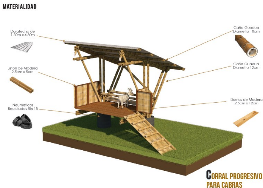
Figura 1 – Materialidad de la infraestructura para cabras
