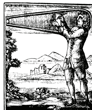
Fig. 1 - Representação das imagens formadas por um pequeno orifício em uma câmara escura.
