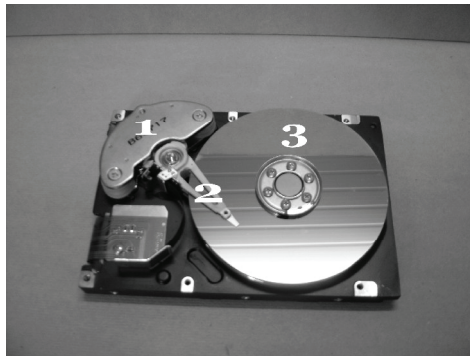
Fig. 1- Componentes internos do HD: 1- conjunto de ímãs; 2- cabeça de leitura/gravação 3- disco rígido.
