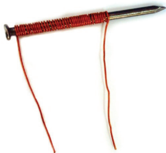
Fig.2 - Extremidades livres do fio condutor.
