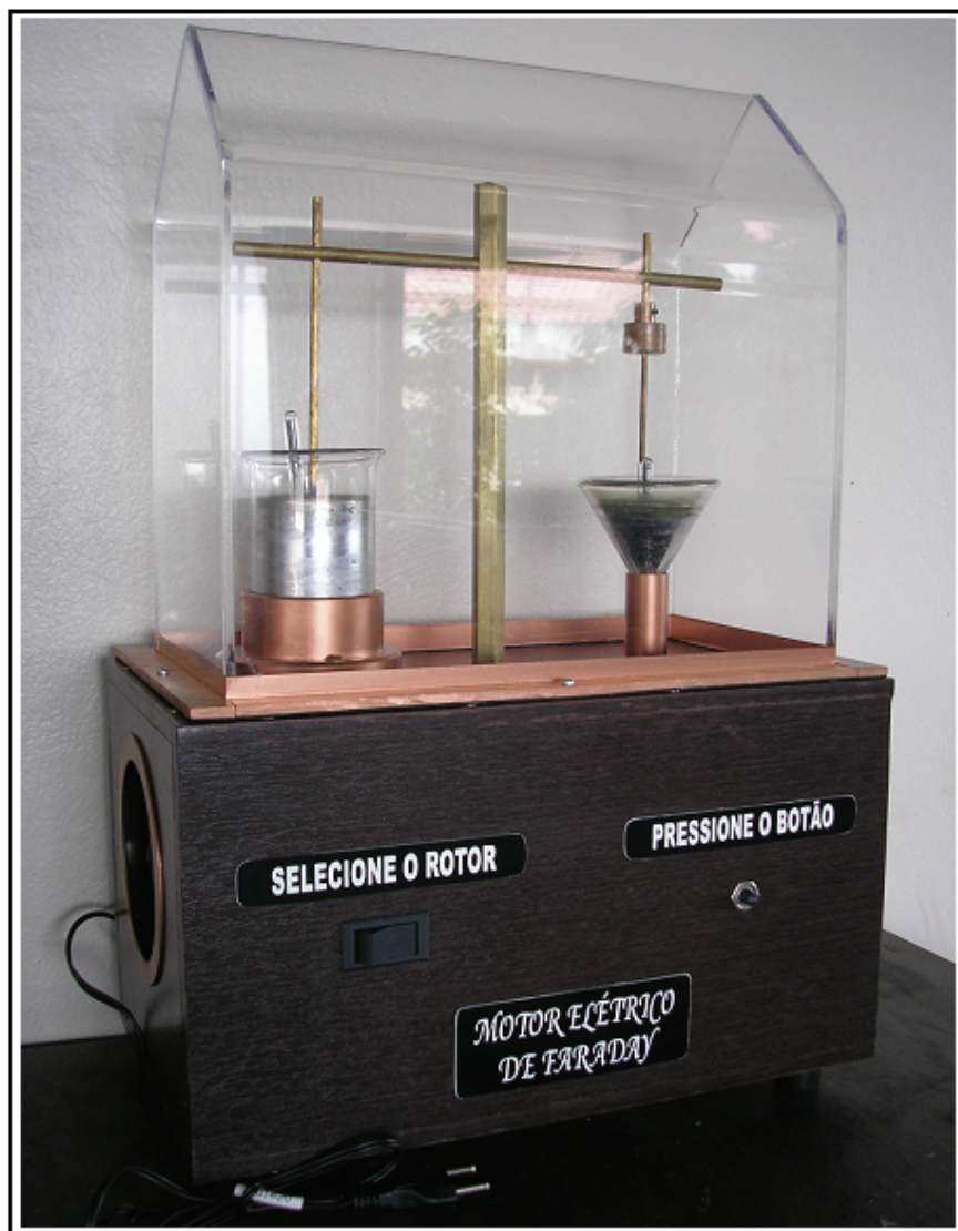
Fig. 6 – Foto do Motor Elétrico de Faraday proposto. As revoluções dos rotores são próximas de 2 rotações por segundo, com uma ligeira diferença para a versão da haste móvel.
