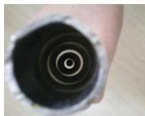
Fig. 2 – Ímã em formato esférico em queda vertical no interior do tubo de alumínio (fotografado de cima).
