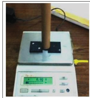
Fig. 11 – Valor médio para o registro da balança durante a queda do ímã em um tubo de PVC:
