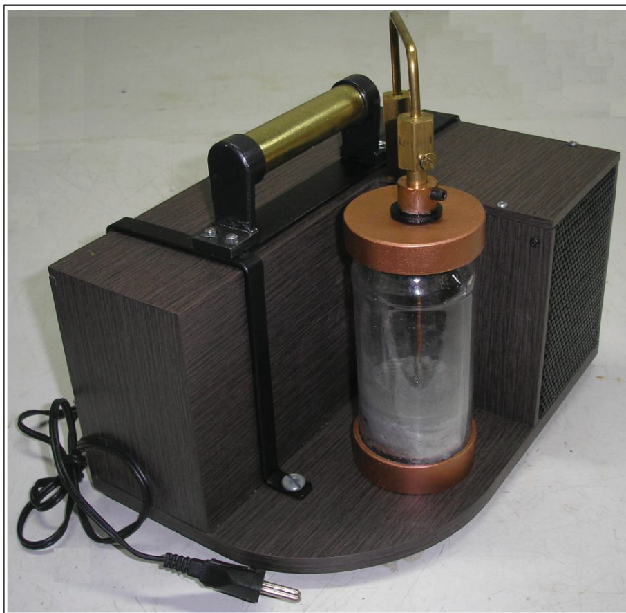
Fig. 6 – Versão compacta do motor elétrico de Faraday para demonstração em sala de aula.
