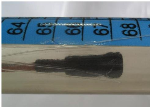
*Fig. 18 – Sonda acoplada ao microfone, inseridos no interior do tubo.*
