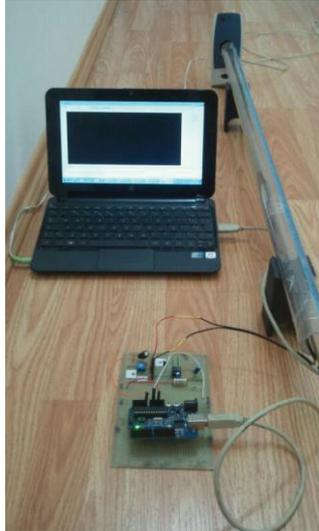
*Fig. 17 – Montagem completa do Tubo de Kundt adaptado.*
