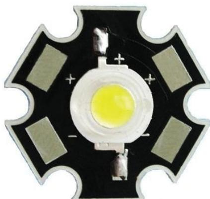
*Fig. 5 – LED de potência montado sobre a estrela de alumínio.*
