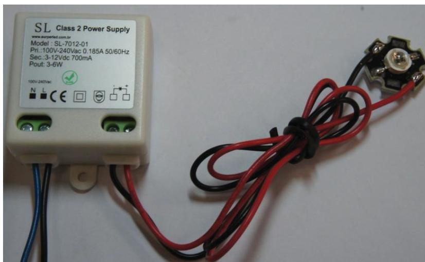
*Fig. 4 – Fonte comercial de 6 watts com LED de potência.*
