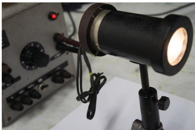
*Fig. 6 – Fonte óptica da Leybold Optics utilizando lâmpada incandescente.*
