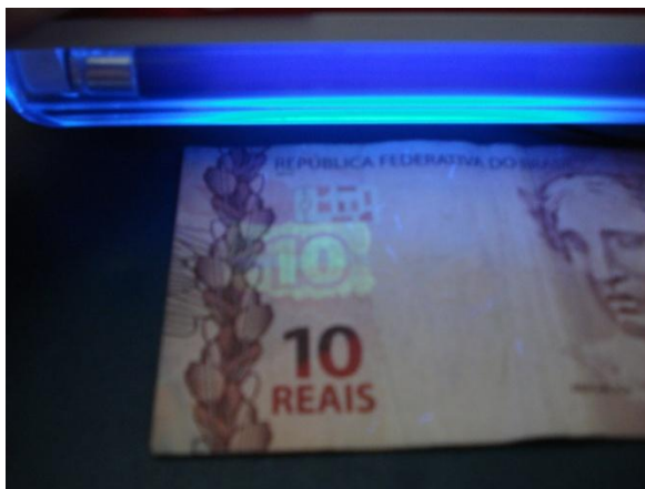
Fig.3 – Algarismos visíveis numa cédula de real iluminada por UV.
