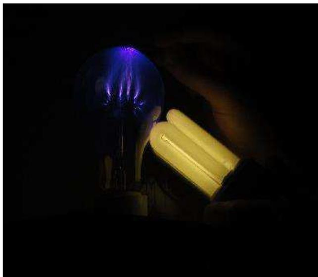
*Fig. 5 – Lâmpada fluorescente e dedos aproximados do globo de plasma alternativo.*
