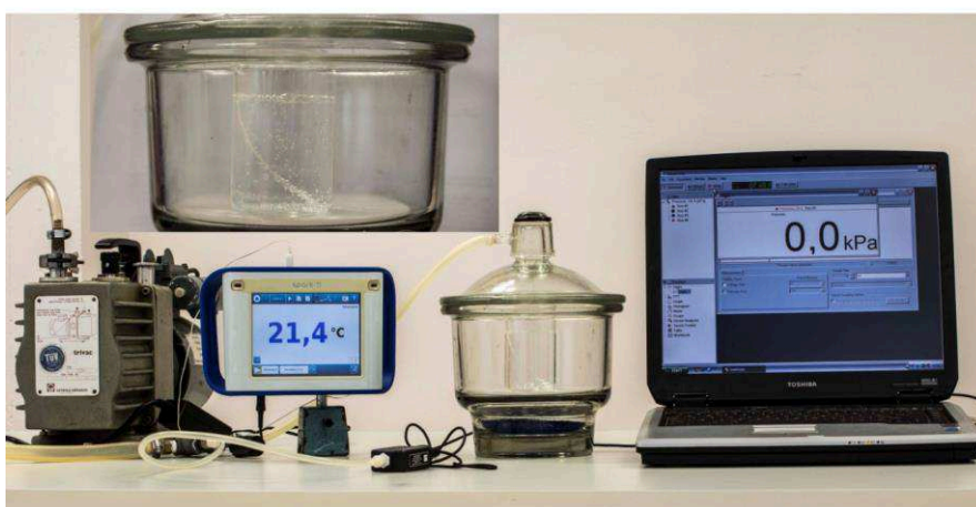
Fig. 4 – Na parte superior da foto é mostrado um sistema de vácuo, no qual uma bomba está ligada a um dissecador, dentro do qual foi colocado um becker com água da torneira; a temperatura e a pressão (atmosférica, do ambiente) são monitoradas. A imagem aumentada mostra uma ampliação do becker; não se notam bolhas na água. Na figura inferior, a bomba de vácuo foi ligada, e a pressão reduzida a um valor inferior a 0,5 kPa (ou pouco menos de 4 mmHg; esse seria o menor valor de pressão detectável pelo instrumento empregado); note (na imagem ampliada do dissecador) a formação das borbulhas, atestando a ebulição da água a 21,4 °C.
