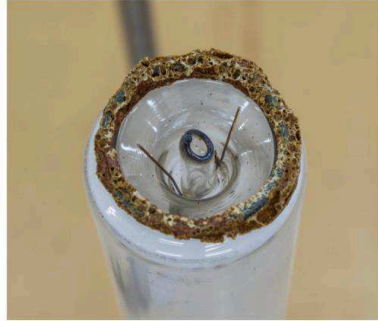
Fig. 1 – À esquerda: quebrando o lacre da extremidade da lâmpada, sob a água. O lacre é o tubo central, com a extremidade mais escura, que aparece na imagem da direita.
