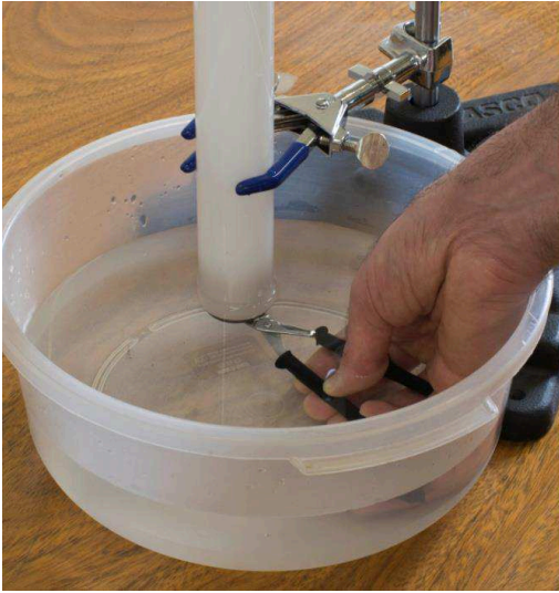
Fig. 1 – À esquerda: quebrando o lacre da extremidade da lâmpada, sob a água. O lacre é o tubo central, com a extremidade mais escura, que aparece na imagem da direita.
