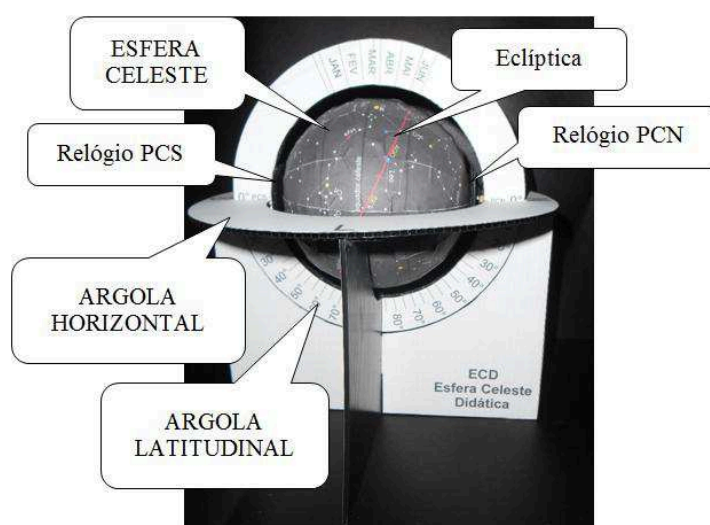
Fig. 11 – Particularidades da esfera celeste didática (ECD). Fonte: Autoria própria.
