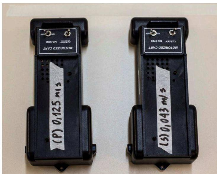
Fig. 4-b – Os carros a pilha empregados na simulação do movimento de ondas  $s$  e ondas  $p$ , descrita acima. Os valores das velocidades aparecem nas etiquetas coladas nos carros.
