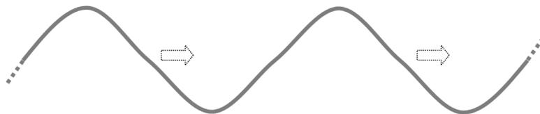
Fig. 1 – Ondas transversais numa corda flexível. Um pequeno elemento da corda se move para cima e para baixo, enquanto que a perturbação se propaga horizontalmente (para a esquerda, na figura), o que caracteriza uma onda transversal.
