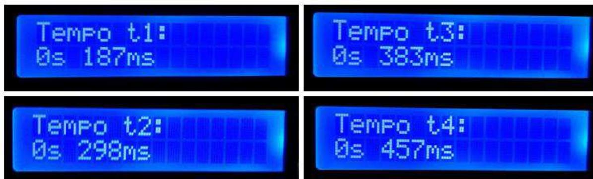
Fig. 4 – Exibição no display LCD do tempo de queda ao atravessar cada anel da torre de queda livre.
