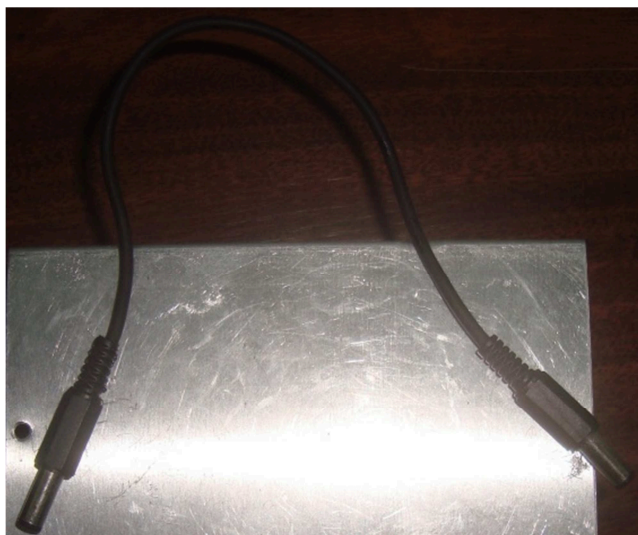
Fig. 14 – Cabo de ligação entre o pré-amplificador e a fonte de alimentação.
