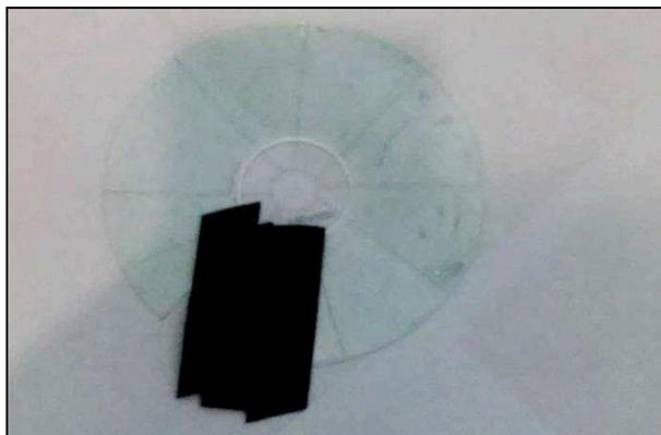
Fig. 4 – Removendo a película refletora do CD.
