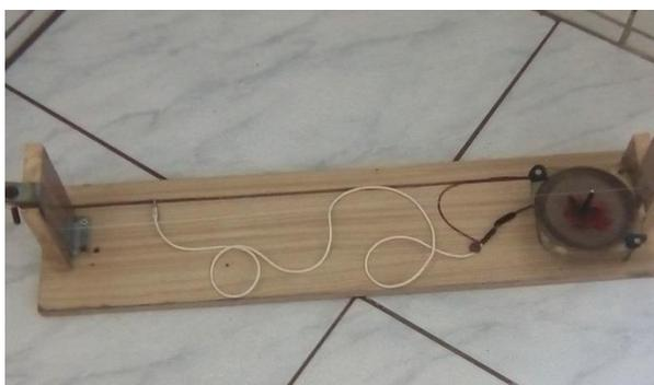
Fig. 1 – Gerador de ondas estacionárias. Fonte: os autores.
