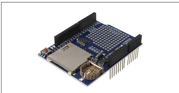
*Fig. 4 – Escudo data logger para Arduino Uno. Na figura vemos o slot para cartão SD e o suporte para bateria modelo CR1220 de 3V. O escudo possui uma pequena área para prototipagem de grande utilidade.*
