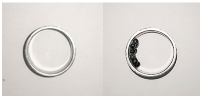
Fig. 6 – Detalhe do anel utilizado na atividade, a esquerda ele na condição homogênea e a direita com a adição de esferas de chumbo, condição não homogênea (Acervo dos autores).
