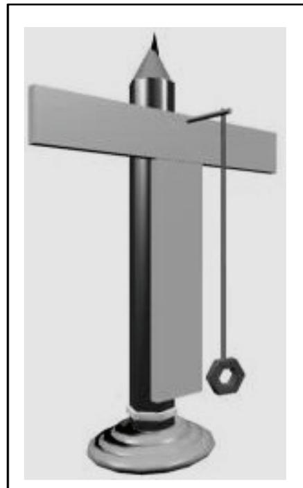
*Fig. 5 - Balança em forma de T suspensa pelo fio de prumo.*
