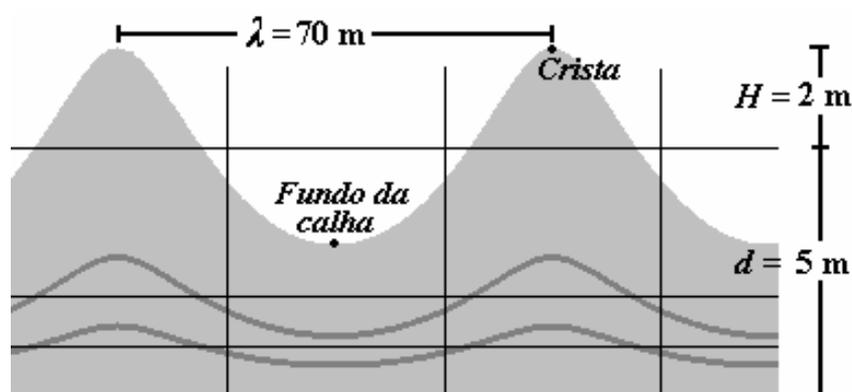
Fig. 4 - Perfil não-senoidal de uma onda marítima, com comprimento de 70 m e amplitude transversal máxima de 2 m, propagando-se em uma região rasa.
