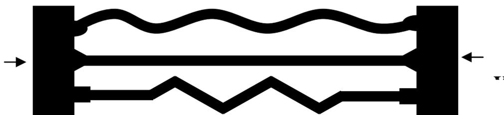
*Fig. 2 - Exemplo de associação em paralelo de três resistores semelhantes aos mostrados na Fig. 1.*
