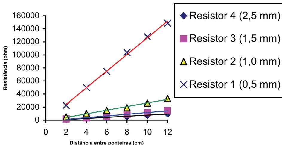
Fig. 5 – Família de curvas mostrando a dependência da Resistência x Comprimento para resistores desenhados de 12 cm de comprimento e de diferentes larguras.
