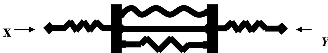
*Fig. 4 - Exemplo de associação mista de cinco resistores semelhantes aos mostrados na Fig. 1.*
