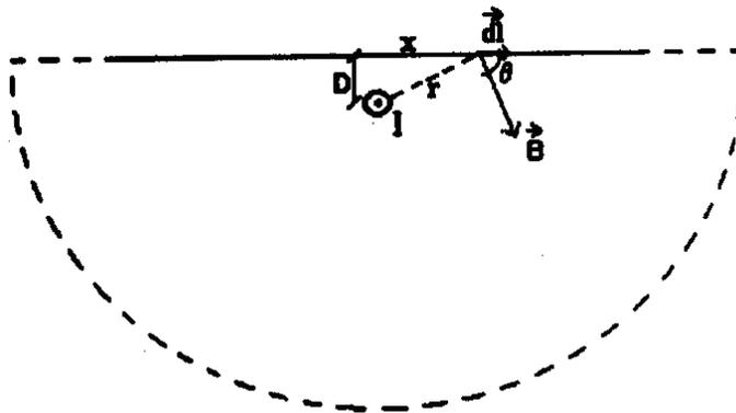
**Solução 1:** Aplicando-se a Lei de Ampère ao percurso fechado formado pela reta e pela semi-circunferência de raio infinito representadas na figura, obtém-se:
