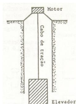
A figura se refere a um elevador e o seu sistema de tração (motor e cabo). Através do cabo o motor pode exercer uma força sobre o elevador (são desprezíveis as forças de atrito e de resistência do ar sobre o elevador).
