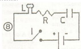
8. No circuito da figura 8, L é uma lâmpada, R é um resistor, C é um capacitor descarregado e I, um interruptor aberto. Ao se fechar o interruptor:
