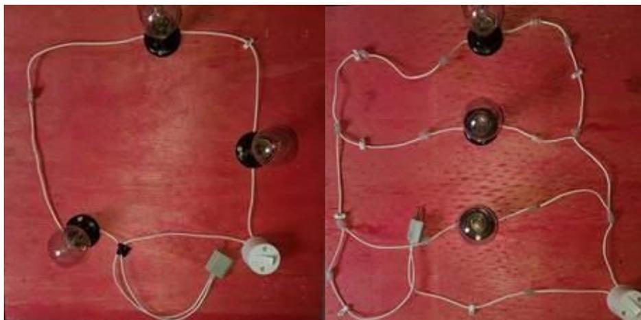
Fig. 2 – Circuitos elétricos em série e paralelo. Fonte: construção própria.
