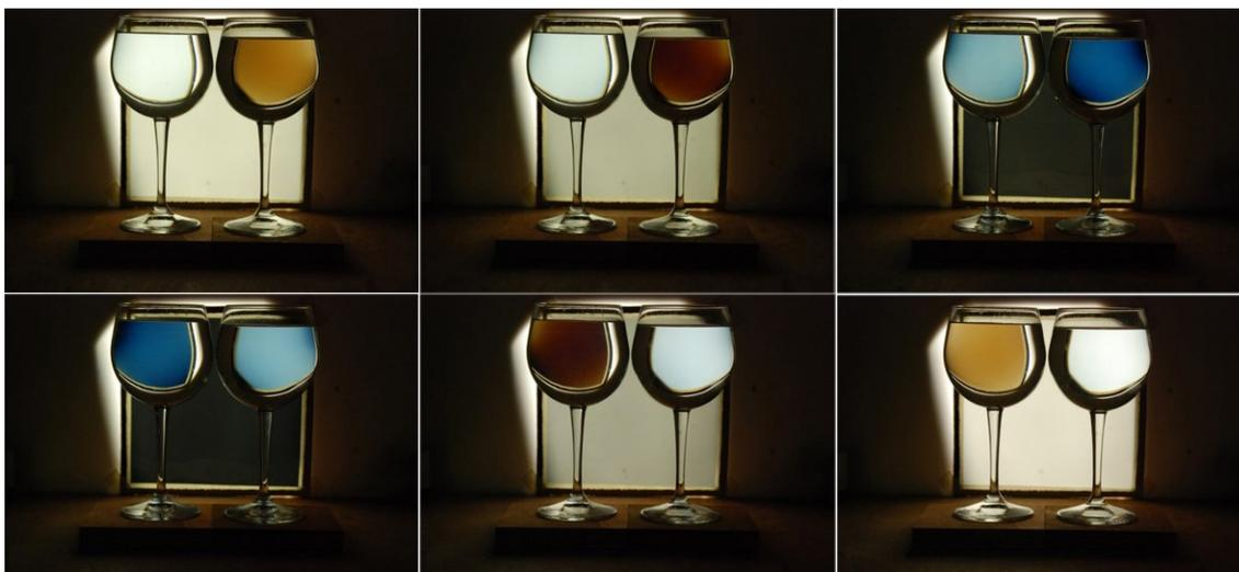
*Fig. 16 – Rotación de la polarización de una solución de fructosa (a la izquierda) y de sacarosa (a la derecha). Cuando se rota el polaroid frente a la cámara, en sentido horario, es posible observar secuencias de colores en las dos soluciones, que son una opuesta a la otra. Esto se debe a que la sacarosa rota la polarización hacia la derecha (dextrorrotatoria) y la fructosa hacia la izquierda (levorrotatoria).*
