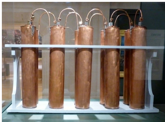
Fig. 7 – Associação de pilhas de Daniell para redes telegráficas. Fonte: < http://www.victorianweb.org/painting/reviews/decoded1.jpg >. Acesso em: 01 jun. 2021.
