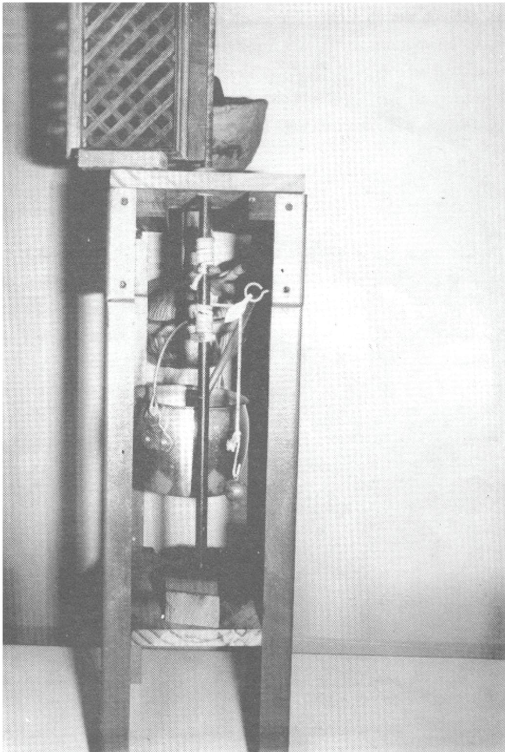
*Em primeiro plano, aparecem o contrapeso e o cilindro de ferro, preso à porta (de modo que ela gira, quando o cilindro gira). Em segundo plano, o balde e a parte final do sifão. Ao fundo, o recipiente esférico, onde a água é colocada. O*
