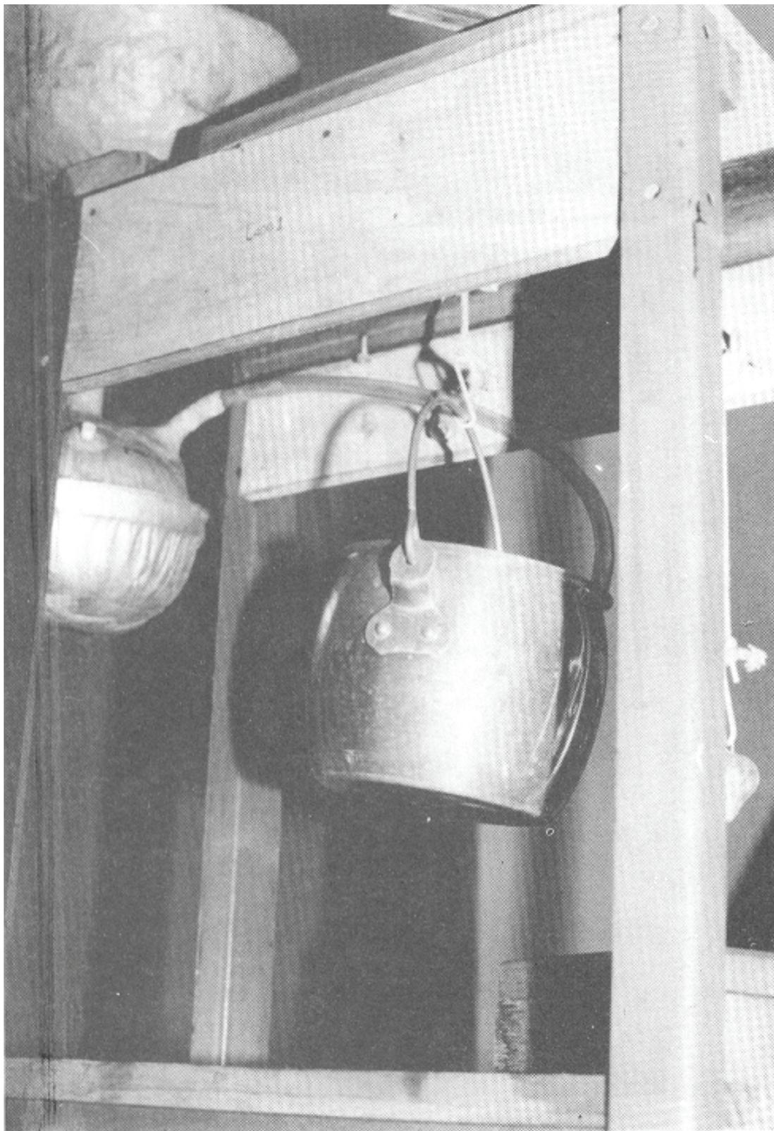
*Detalhe do sistema termodinâmico, mostrando o recipiente esférico: Aparece o pino que tampa o orifício de saída do ar. A foto mostra o sifão, saindo do recipiente até o balde.*
