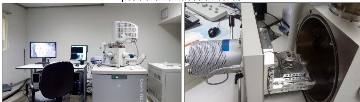
Figura 05 - (a) Visão geral do equipamento de MEV utilizado no IME e (b) detalhamento do posicionamento das amostras.
