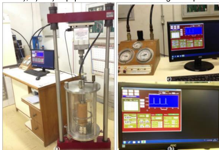
Figura 04 - a), b) e c) Equipamento Triaxial de Cargas Repetidas do IME.
