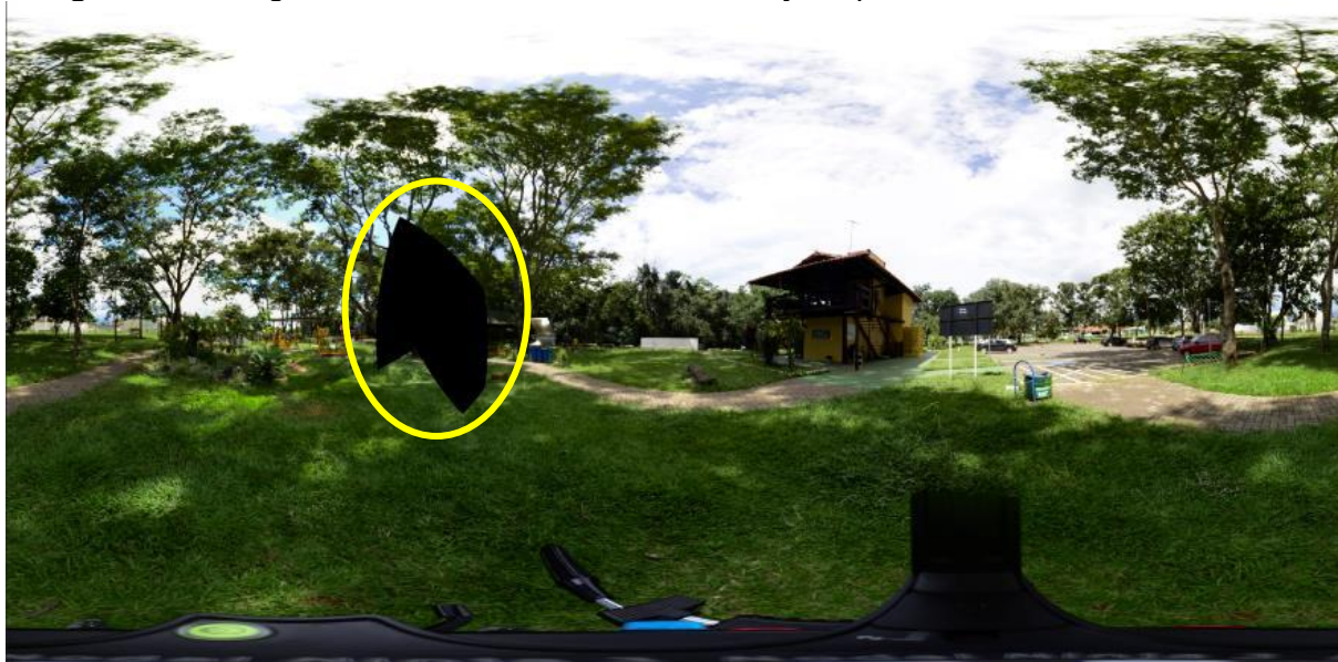
Figura 10 - Imagem 360° com ausência de informações pela falta de recobrimento total.
