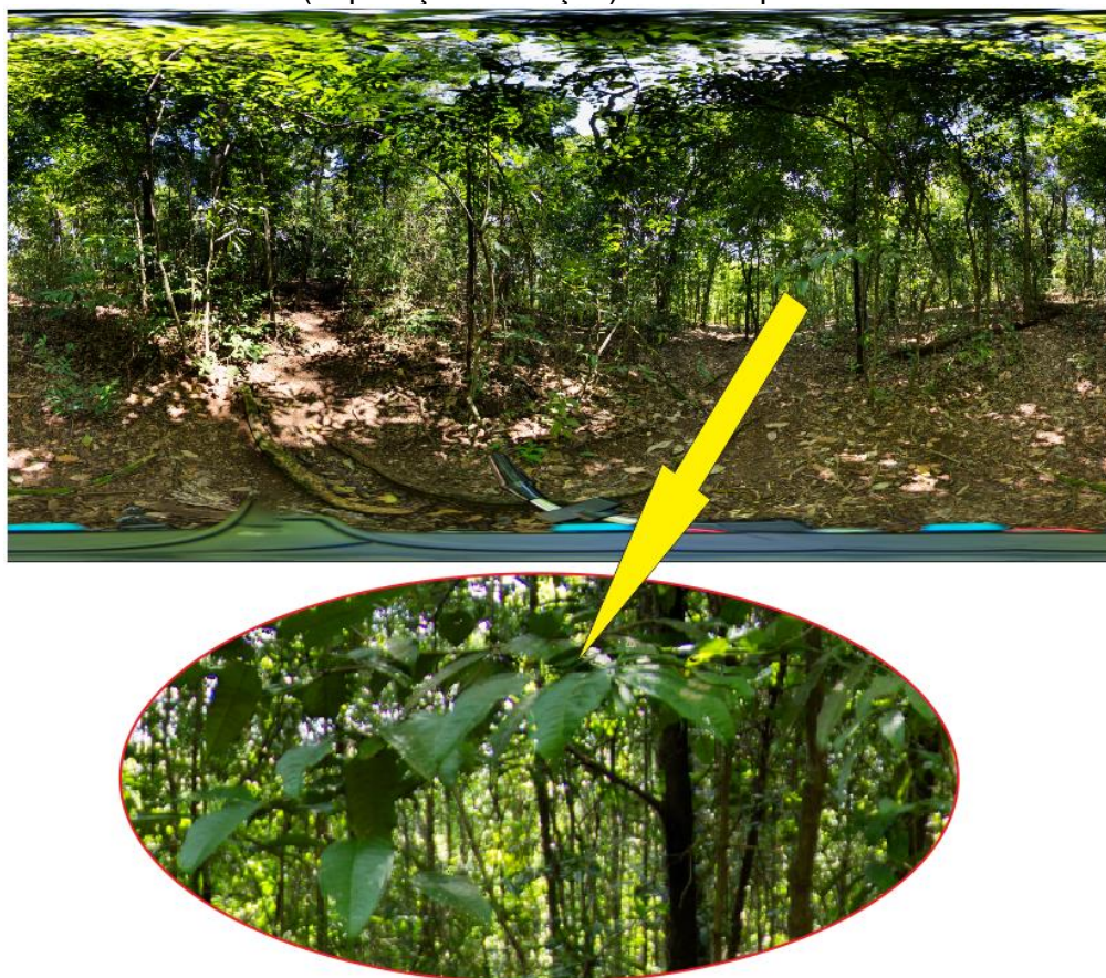
Figura 09 - Efeito fantasma (duplicação de feição) causado pelo vento.
