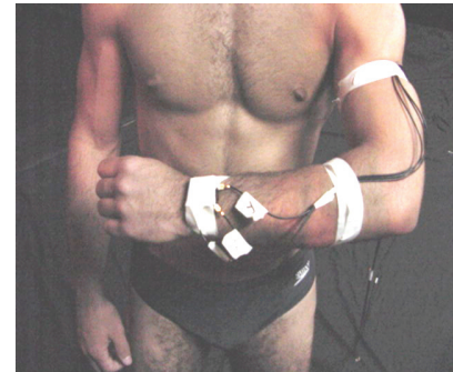
Figura 1. Forma de fixação do acelerômetro no segmento corporal punho
