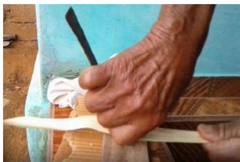
Figura 2: Imagem da palha sendo rachada com o ferro. Fonte: Coutinho (2020, p. 40).
