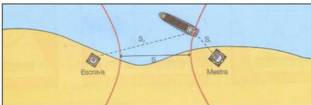
**Figura 3:** Ilustração do funcionamento do sistema LORAN e uma cônica (hipérbole)
