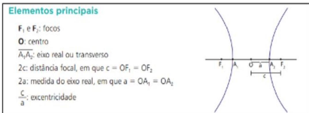
**Figura 11:** Ilustração dos elementos principais da figura Cônica Hipérbole em (L1)
